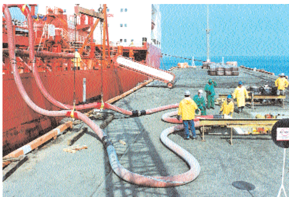
Sulfuric Acid loading. / Embarque de ácido sulfúrico.
