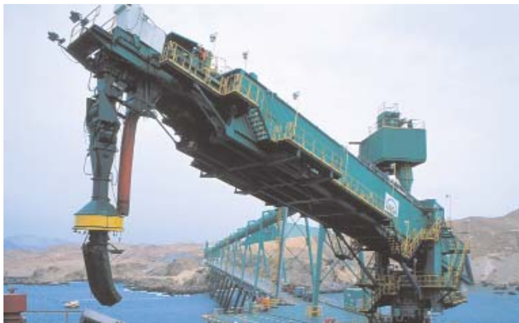
Cargador de brazo giratorio. / Fixed slewing radial arm shiploader.
